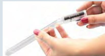
Mélanger doucement à l'aide d'une tige de verre ou d'une pipette pasteur.
