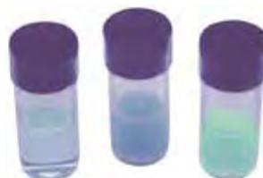
Détecter la présence de coliformes (E. coli) dans des échantillons d'eau au moyen de 2 réactifs. Détecter les coliformes (coliformes totaux) et E. Coli spécifiquement.
