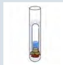
Incliner les tubes pour chasser l'air piégé dans le creux du bouchon.
