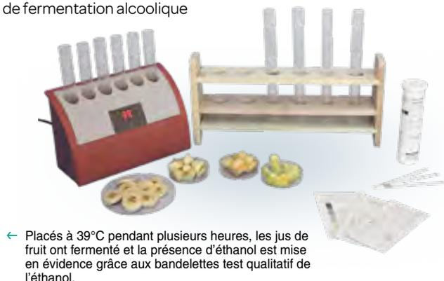
← Placés à 39°C pendant plusieurs heures, les jus de fruit ont fermenté et la présence d'éthanol est mise en évidence grâce aux bandelettes test qualitatif de l'éthanol.
