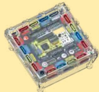
Elle donne accès via des connecteurs à 14 entrées/sorties numériques et 6 entrées analogiques. Elle intègre un accéléromètre, un afficheur 64 x 32 pixels et une carte SD. Elle accepte les capteurs Plug'Uino®, Grove ou Arduino®.
